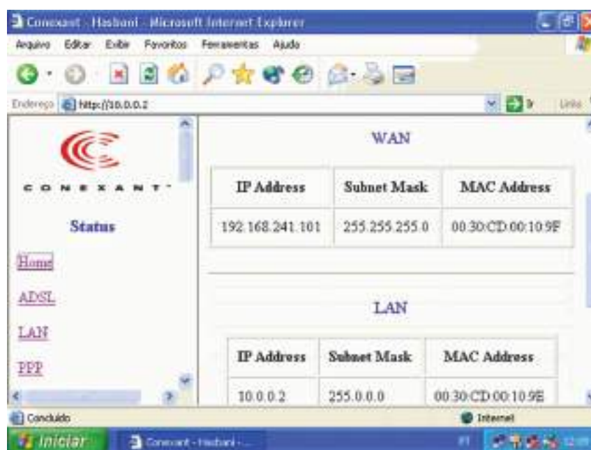
Figura 175: Verificação do estado da conexão.
