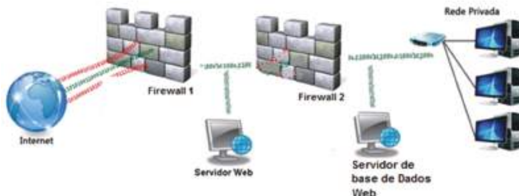
Figura 283: Solução para a falha de segurança apresentada pela arquitetura DMZ tradicional.
